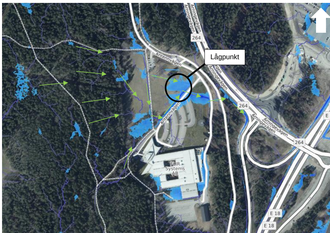
Figur 14. Flödesvägar och ansamlingsplatser vid skyfall i blått för nuläge (SCALGO Live). Flödespilar (grönt) visar riktning.
